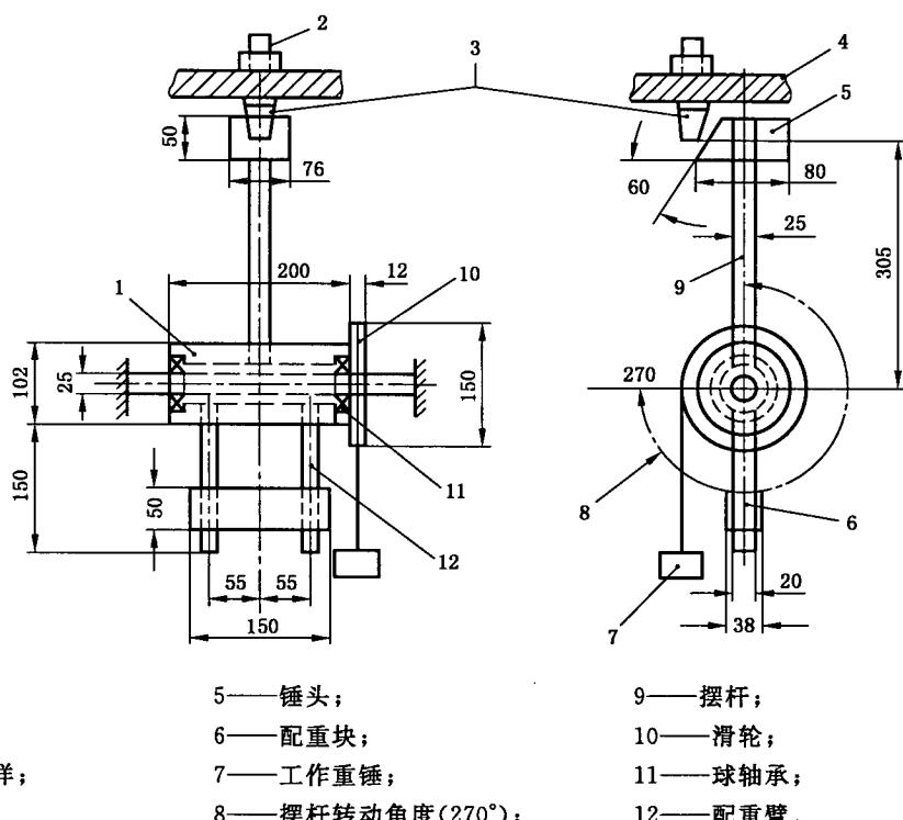
图 1 碰撞试验设备示意图
